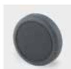
Rad: UJI Radkörper: Polyamid, Lauffläche: TENTEprene (Thermoplastischer Gummi), Gleitlager
