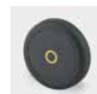
Rad: XGI elektrisch-leitfähig Radkörper: Polyamid, Lauffläche: TENTEprene (Thermoplastischer Gummi), Gleitlager
